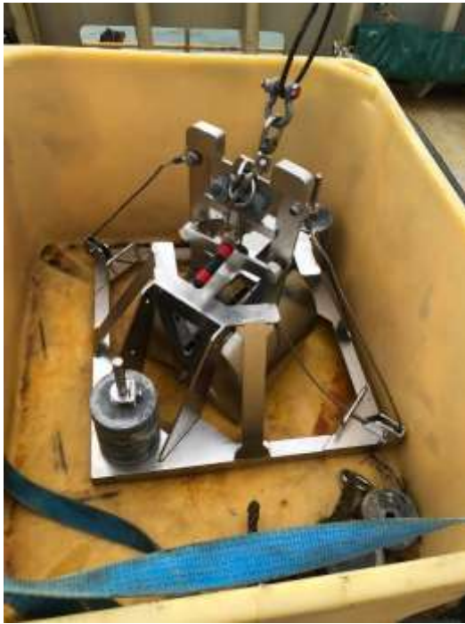
Mynd 1: Sýnatökubúnaður notaður við úttekt á botndýralífi á fyrirhuguðu losunarsvæði utan Hornafjarðaróss. Botngreipin KC-daygrab leggst á hafsbótinn, við það lokast skófla sem grípur sýni af botninum.
